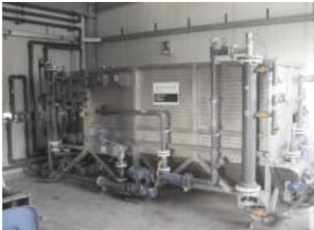
Abb. 2: Patentierte Microfloat® Druckentspannungsflotation der Firma Enviplan
